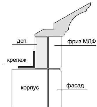
Схема крепления карнизов
